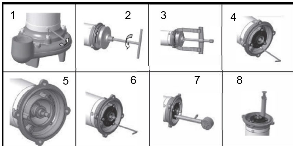
Abb.7-1: Wartung der Pumpe
